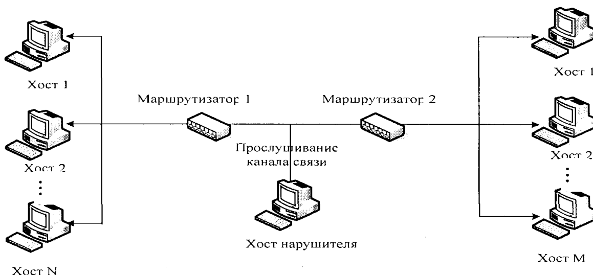
"Рисунок 6. Схема реализации угрозы "Анализ сетевого трафика"
